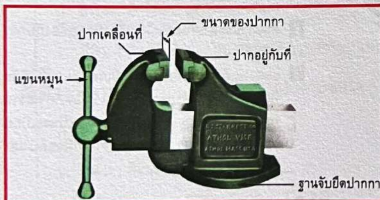
รูปที่ 2.1 ส่วนต่าง ๆ ของปากกา และการบอกขนาดของปากกา
